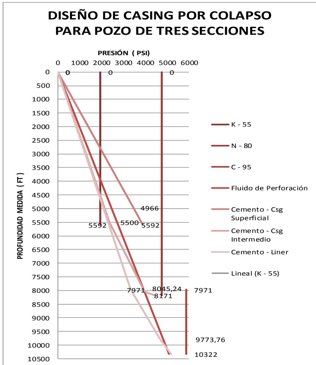
Gráfico 6.2: Presiones que actúan en un pozo - diseño de casing por colapso - pozo de tres secciones
