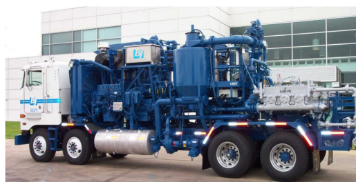
Figura 1.9 - Unidad de cementación on-shore. Fuente: BJ-Services.
