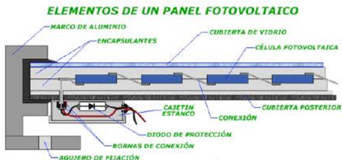
Figura 2.9: Sección del módulo fotovoltaico
