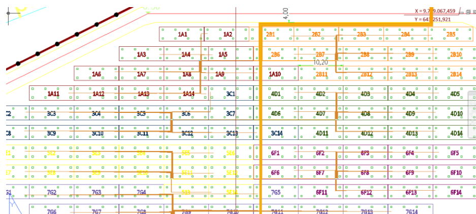
Figura 3.14: Ubicación de los paneles en el terreno.
