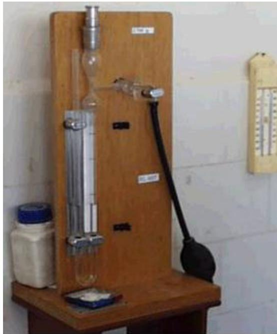
**Figura 19: Permeabilímetro**
