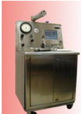
**Figura 14: Consistómetro presurizado**
