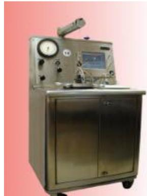
**Figura 13: Consistómetro presurizado**
