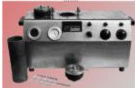
**Figura 12: Consistómetro de presión atmosférica**
