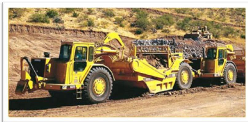
**FIGURA 3.4.9:** Traíllas y Mototraíllas
