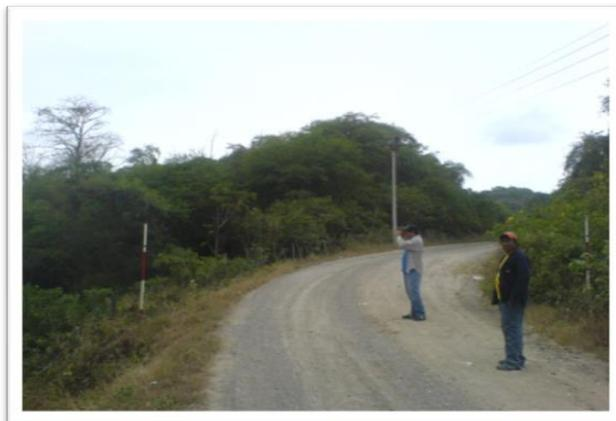
**Fotografía #15:** Levantamiento topográfico con clinómetro y mira o estadia para las secciones transversales, abscisa 2+200
