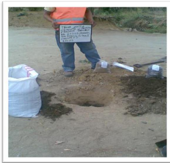
**Fotografía #22:** Excavación a una profundidad total 1.5 metros y muestras de material obtenidos de la calicata #5, abscisa 2+556 lado izquierdo
