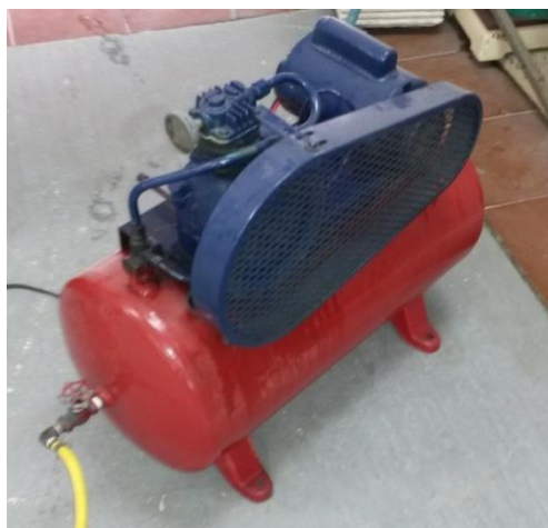
Foto 2: Compresor empleado para la limpieza del reactor
