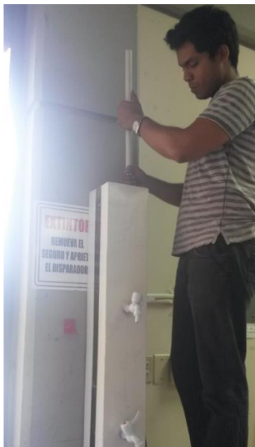
Foto 9: Mezclado Manual, lento 1 minuto, rápido 10 minutos.
