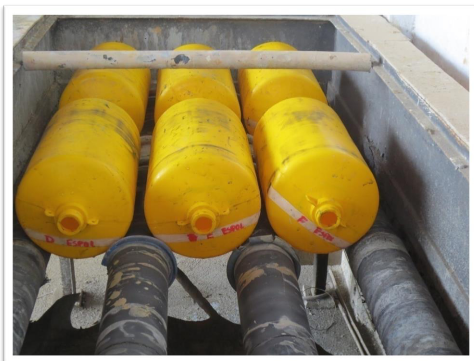
Anexo 47. Cianuración en botellas de concentrado sulfuroso
