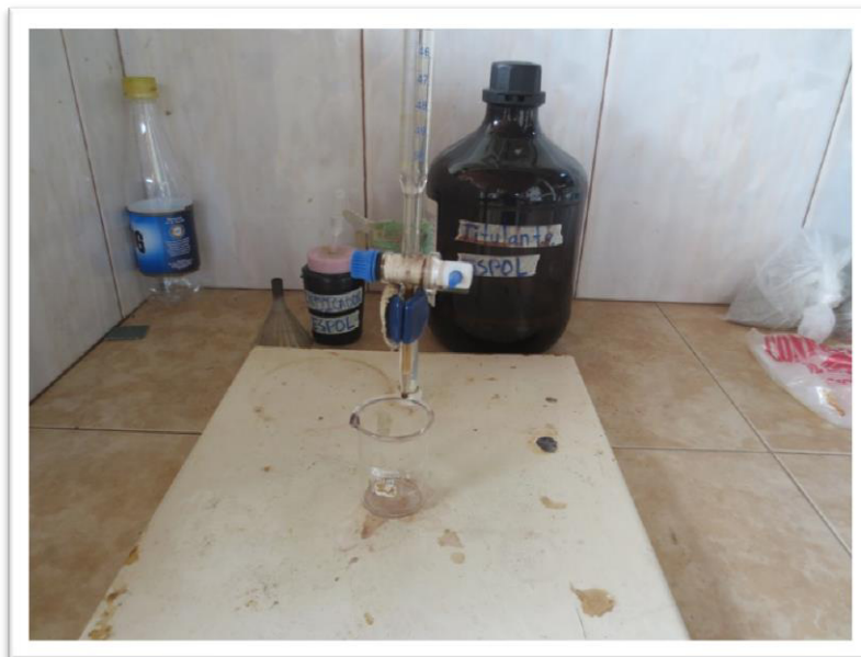
Anexo 36. Titulación para medir concentración de cianuro en las muestras
