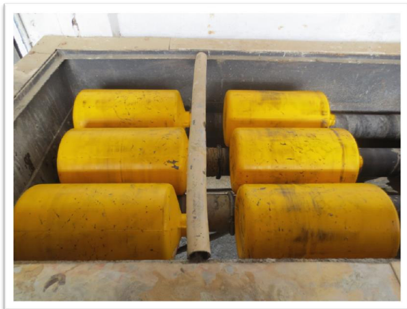
Anexo 34. Prueba de cianuración en botellas
