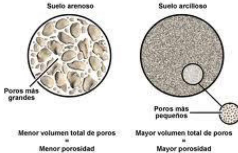
FIGURA13: Porosidad de suelos arenosos y suelos arcillosos
