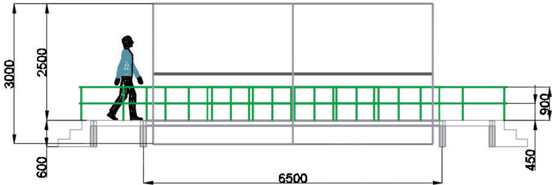
Figura 3- 2 Dimensionamiento de Cilindro y Plataforma.
