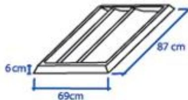
**Figura 2.2: BANDEJA PARA TRANSPORTAR BANANO.**
