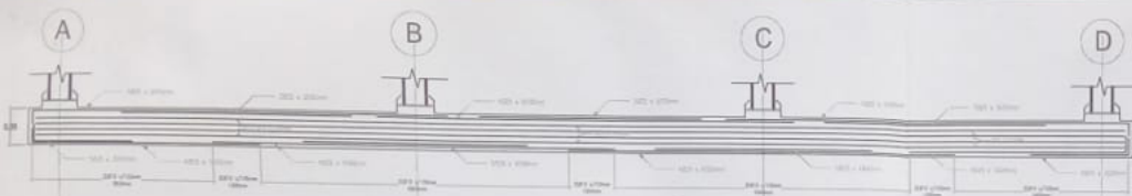
VIGA DE CIMENTACIÓN EJE X ESC: 1:50
