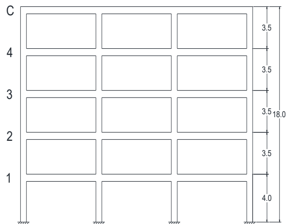
Figura 21: Vista en elevación del edificio Mixto
