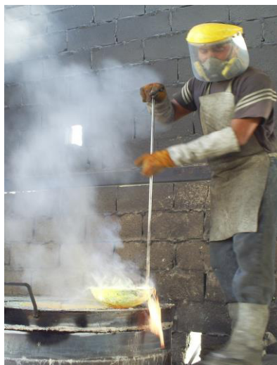
FIGURA 4.2 PROCESO DE VACIADO DE LATON
