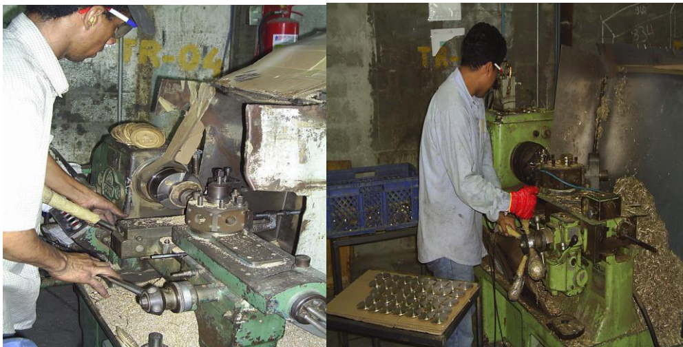
FIGURA 4.10 PROCESO DE DESBASTE Y REFRENTADO
