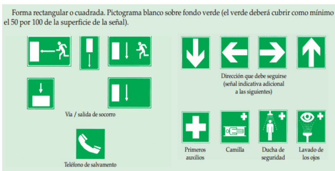
FIGURA 4.21 SEÑALES DE EVACUACIÓN
