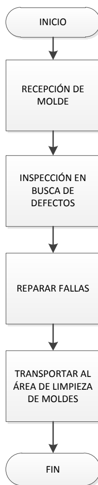
FIGURA 4.13 FLUJOGRAMA REPARACIÓN DE MOLDE
