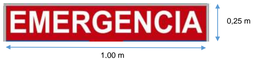
Figura 4.26 Rótulo de emergencia retro iluminado
