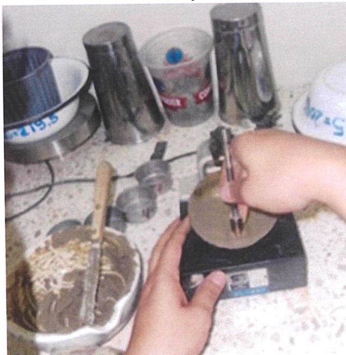
Fotografía 2.12: Suelo fino siendo ensayado en la cuchara de Casagrande
