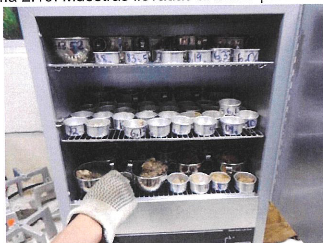
Fotografía 2.10: Muestras llevadas al horno para ser secadas
