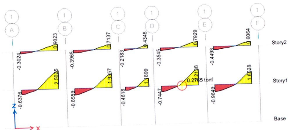
Figura 6.10: Cortantes máximos V_u en vigas EJE 1-1
