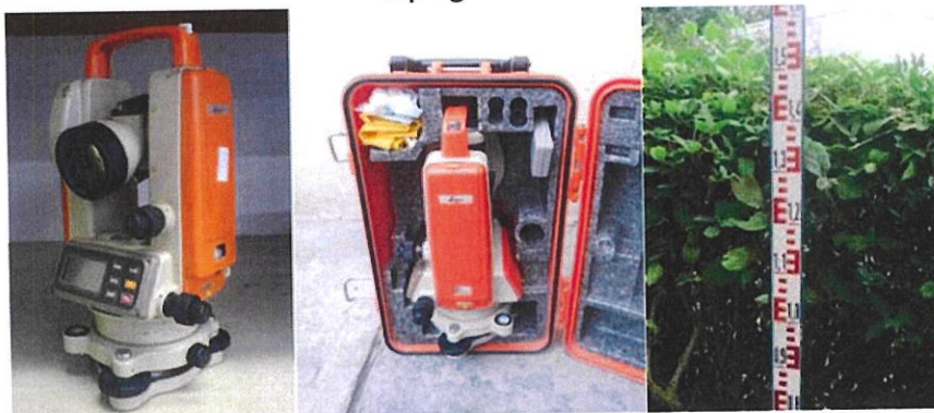
Fotografía 2.1: Teodolito leica t100 y estadia utilizada para el levantamiento topográfico.
