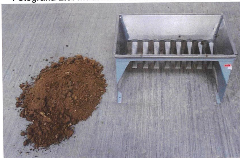
Fotografía 2.9: Muestra de suelo antes de cuartear.
