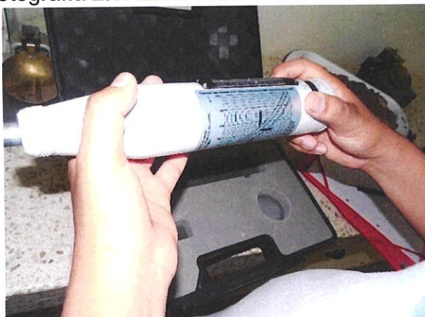
Fotografía 2.8: Esclerómetro utilizado en Sitio.
