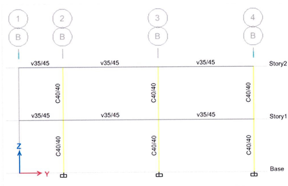
Figura 5.12: Vigas en sentido Y primer piso
