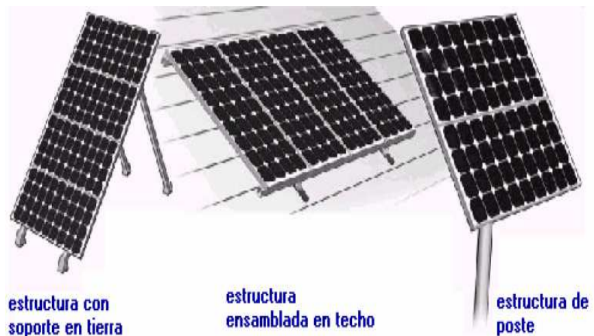
FIGURA 3.2. TIPOS DE SOPORTES FIJOS PARA PANELES SOLARES
