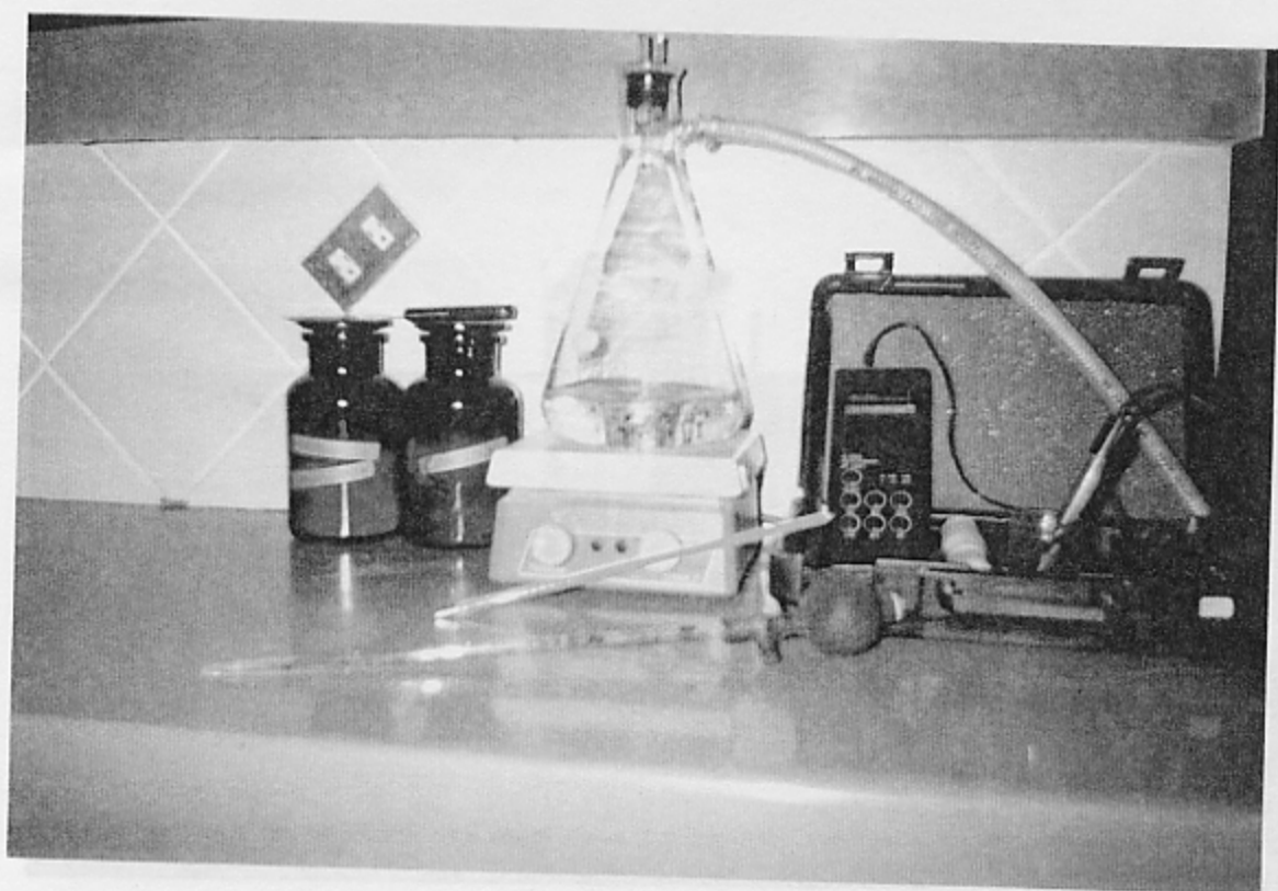
Foto 2. Instrumentación para pruebas de desorción de carbón cargado.
