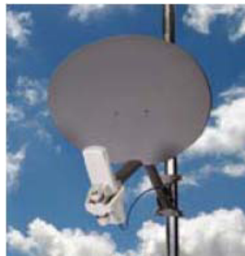
Figura 5.5: Backhaul con disco reflector
