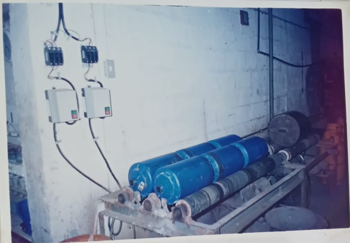
Foto #5 : Pruebas de cianuración en botellas.
