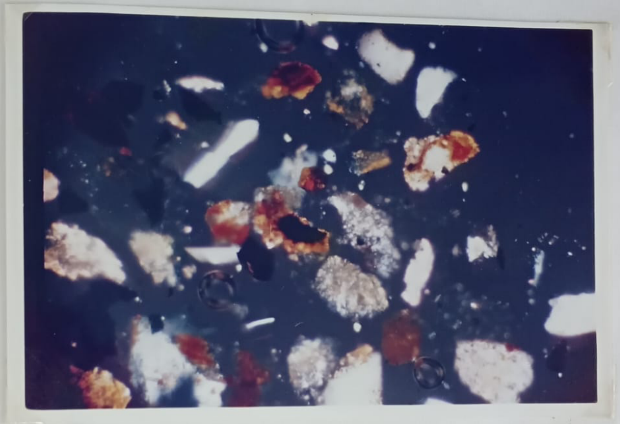
Foto #3.2 : Descomposición de minerales opacos en óxidos de hierro, bordes oxidados con matriz opaca (sulfuros). (NC : 16 x 10).
