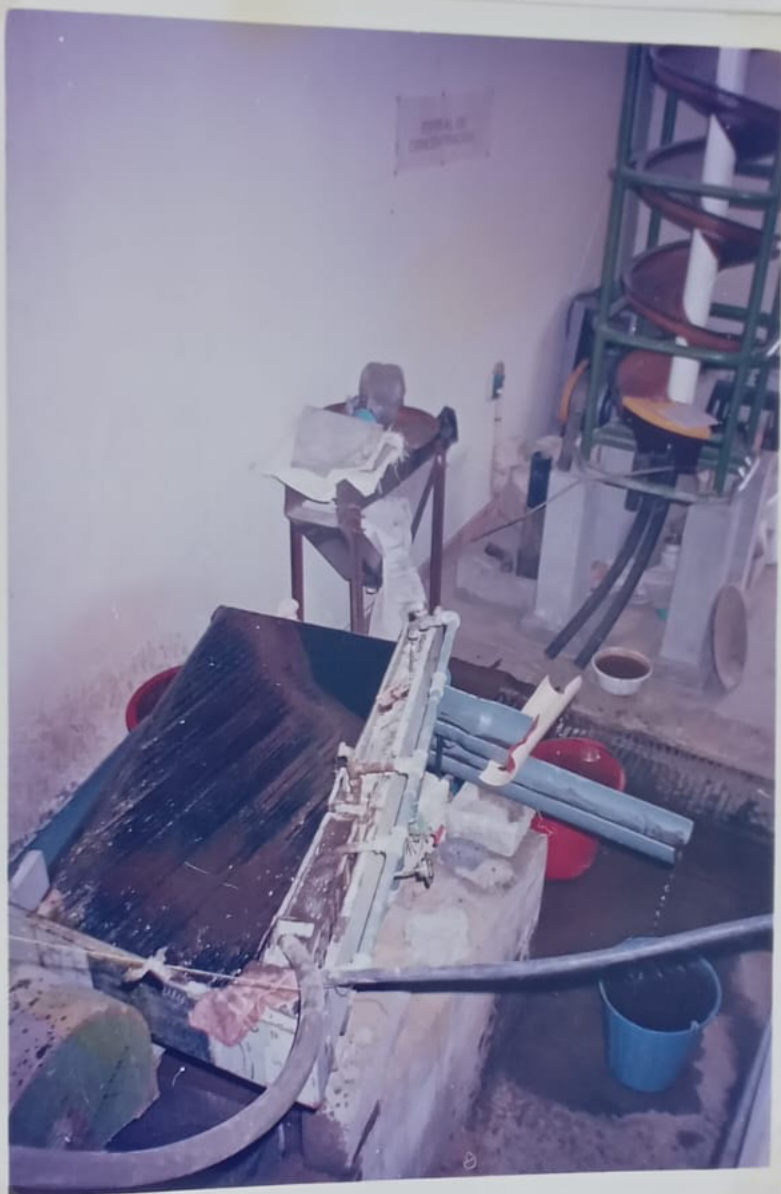
Foto #6 : Prueba de concentración en mesa.
