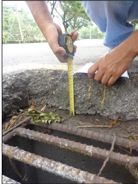
Figura 5-1: Espesor de la capa de rodadura
