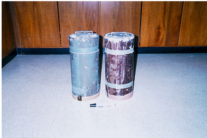
FOTO 4.5 Moldes de PVC utilizados para sumergir las barras de mortero.
