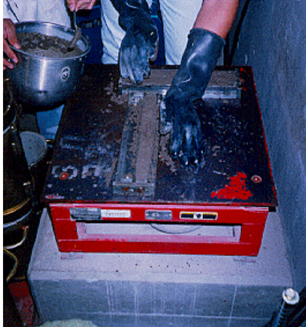
FOTO II Colocación de la primera capa en la elaboración de las barras.
