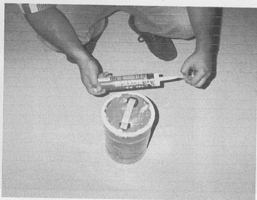
FOTO VI Colocadas las barras, éstas son selladas con silicón para evitar que el calor evapore el líquido en el interior de los cilindros.
