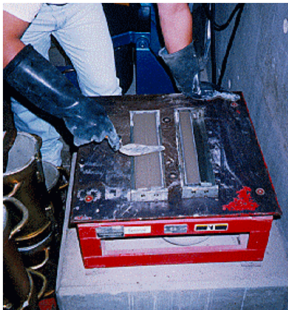
FOTO III Enrasado de los moldes una vez colocada la segunda capa para una muestra analizada.
