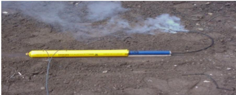
**Foto 3.3 Ensayo para medir la velocidad de detonación de Anfo**
