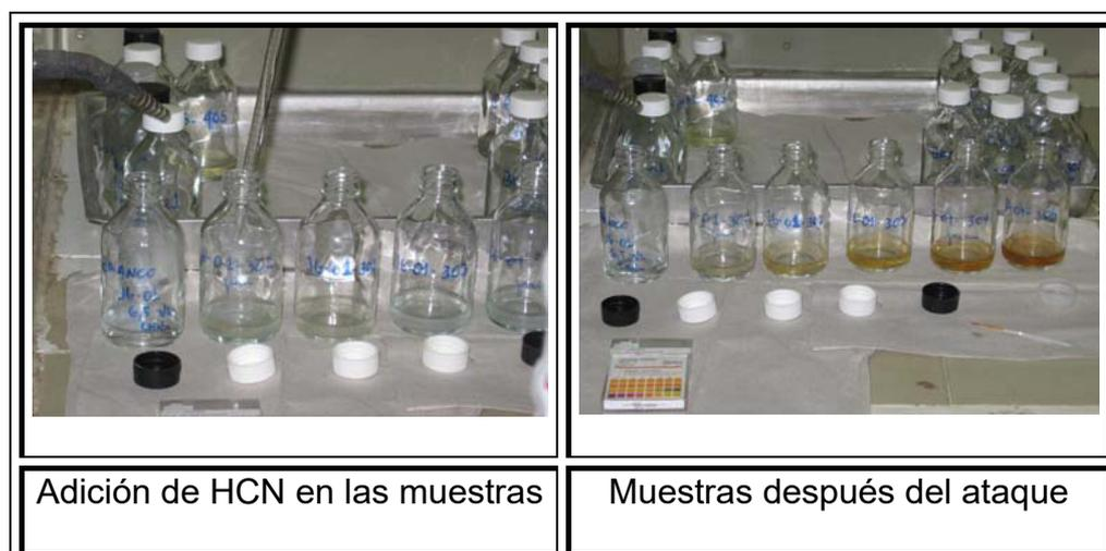
**Fig. 3.2.-** Eliminación de Cianuro en las muestras tomadas en los ensayos de cianuración intensiva.
