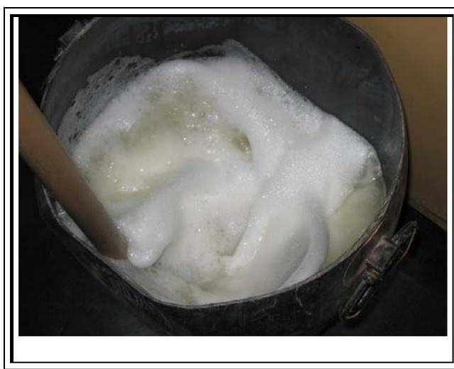
**Fig. 3.5.-** Reacción de la degradación de cianuro, después de añadido los reactivos, con agitación constante.
