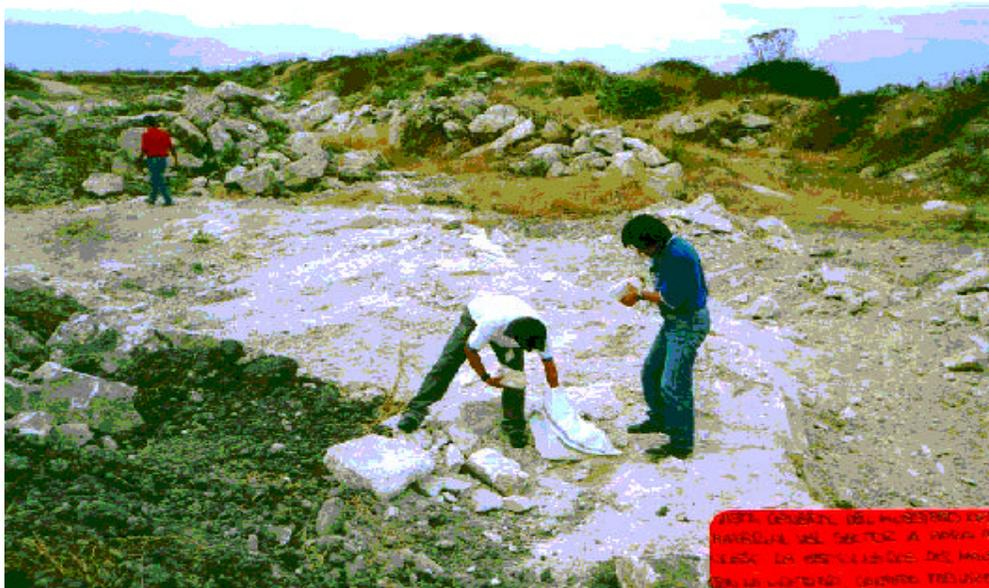
Foto 6: Toma de muestras para control de los materiales de la cantera
