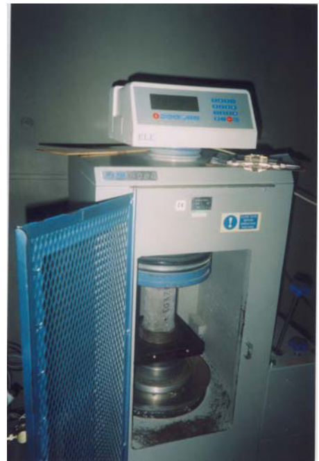
Figura 6.2.1.5 “Rotura de Cilindros por Compresión Simple en la Prensa”. Se realizó esta prueba en cada edad y dosificación de zeolita”
