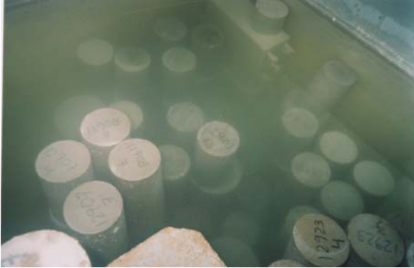
Figura 6.2.1.4 “Cámara Húmeda, donde se colocan los cilindros para que alcancen el contenido de agua óptimo”
