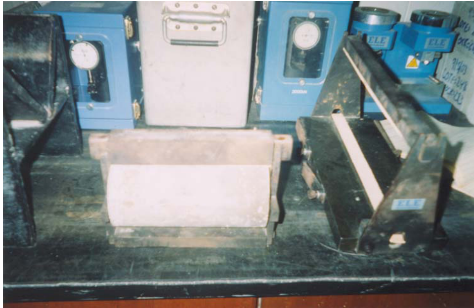
Figura 6.2.2.2 “Estructura requerida para la prueba de tracción por compresión diametral”
