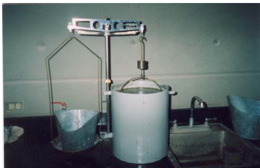
Figura 6.4.2 y 6.4.3 respectivamente “Lectura de peso de cilindro sumergido en agua en la Balanza de Humboldt”
