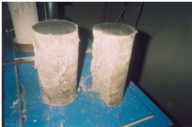
Figura 6.2.1.6 “manera como fallan los cilindros cuando se les realizo la prueba de compresión simple”
