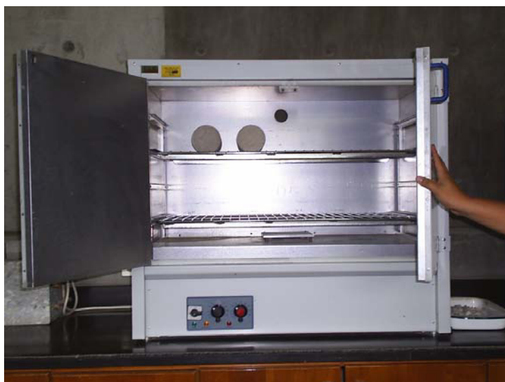
Figura 6.4.5 “ Cilindros colocados en el Horno para ser Secados”
