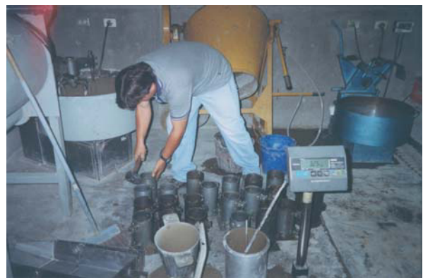
Figura 6.2.1.3 “Llenado de hormigón en los moldes de los cilindros para las diferentes pruebas”
