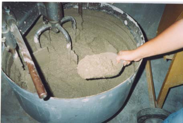
Figura 6.2.1.2 “Diseño de la mezcla de Hormigón en la concretera mediana”. Prueba realizada en todas las dosificaciones”
