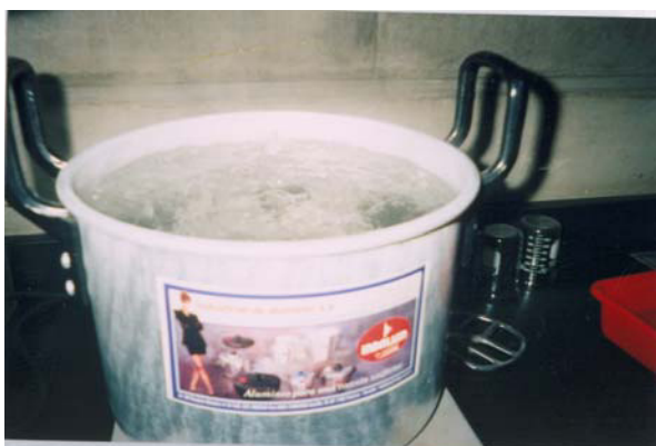
Figura 6.4.4 “Proceso de Hervido de Cilindros durante 5 Horas”
