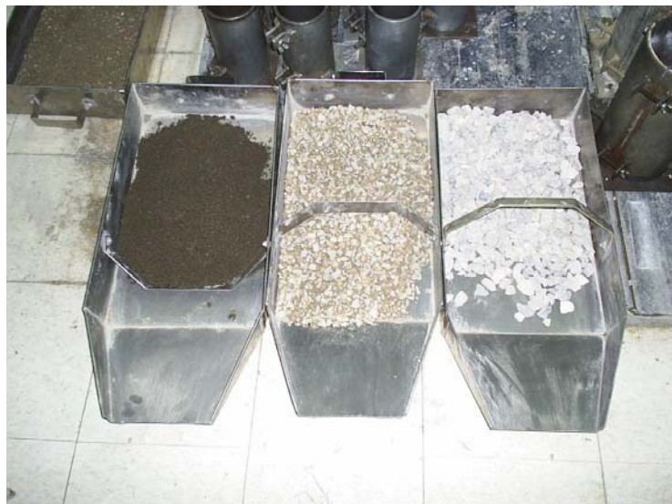
Figura 6.2.1.1 “Agregados utilizados en la preparación del hormigón en estudio”
