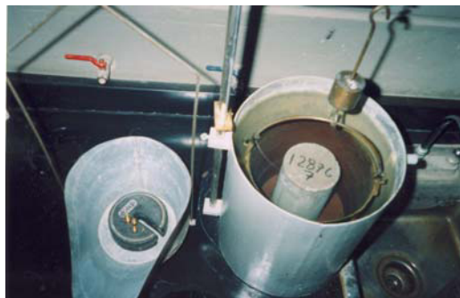
Figura 6.4.2 y 6.4.3 respectivamente “Lectura de peso de cilindro sumergido en agua en la Balanza de Humboldt”
