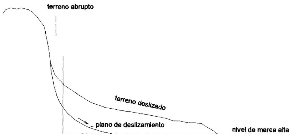
**Figura 4.4:** Perfil de deslizamientos según las suposiciones hechas para el cálculo de volumen desplazado presente en el Peñón Mayor. Comparar con la figura 4.2. El cálculo se hizo restando a la topografía, el nivel de marea alta.
