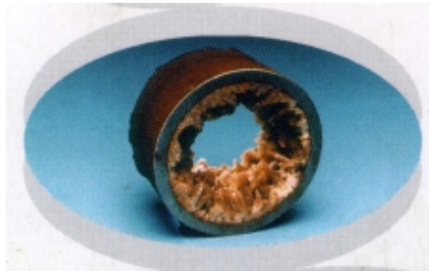
Fig. 1.1 Muestra de tubería incrustada.
