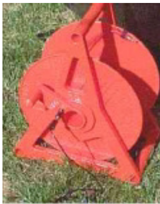
Figura 4.4 Carrete metálico móvil para bobinar el cable.
