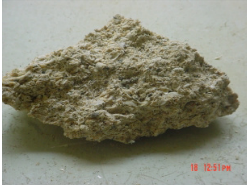
Foto 1. Conglomerado calcáreo con microfósiles.
