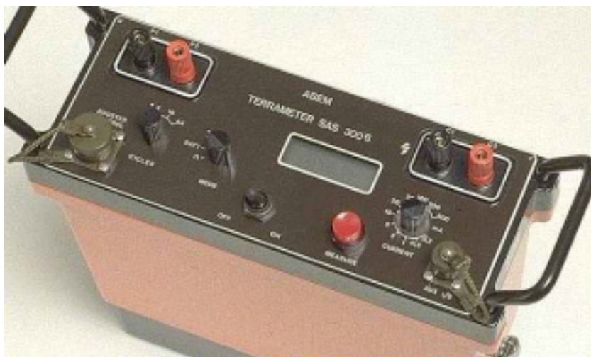
Figura 4.3 Resistivímetro Terrameter SAS-300B.
