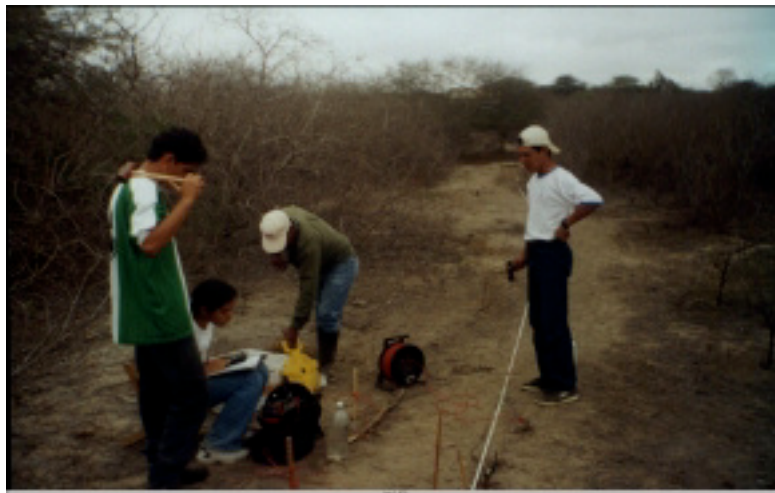
Foto 15. Realización de la Prospección Geoeléctrica.
