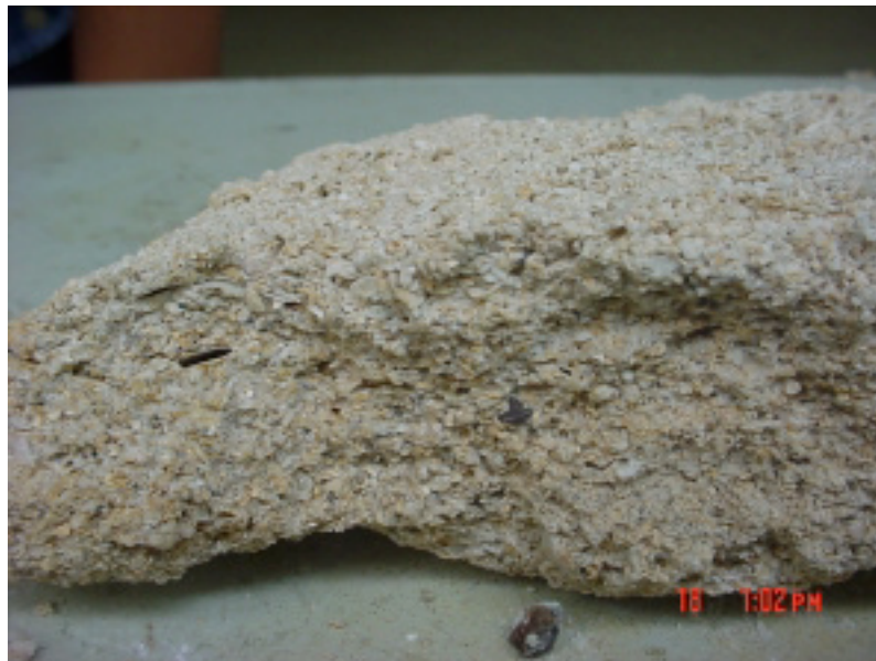
Foto 1. Conglomerado calcáreo con microfósiles.
