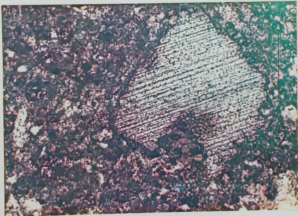
Lámina 1128—Objetivo 6.3 x — Nícoles paralelos. Esparita con macla lamelar relleno una cavidad
