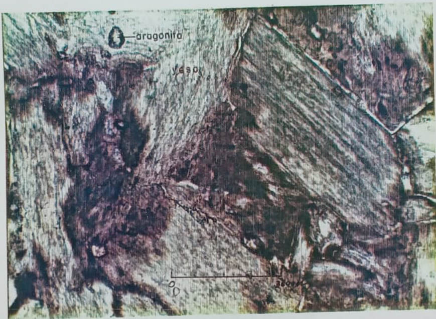
Lámina 1127 - Objetivo 6.3x - Nícoles paralelos. Vista general de un cristal de yeso con inclusiones de aragonita.
