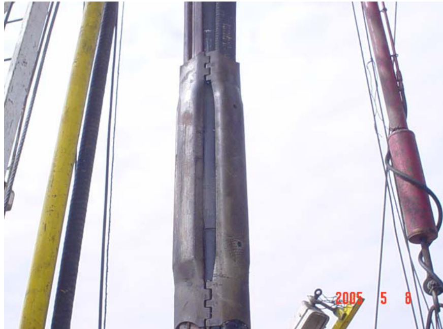
Figura 4.11 Zunchos para sujetar Cable de poder y Líneas.
