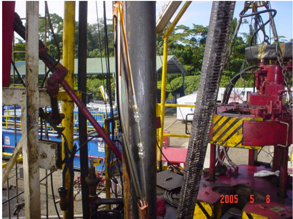
FIGURA 4.12 Líneas Hidráulicas y Cable de Poder
