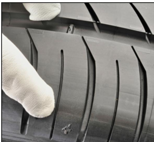
**Figura 35. Testigo de desgaste**
