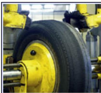
**Figura 42. Proceso de raspado de la banda de rodamiento.**
