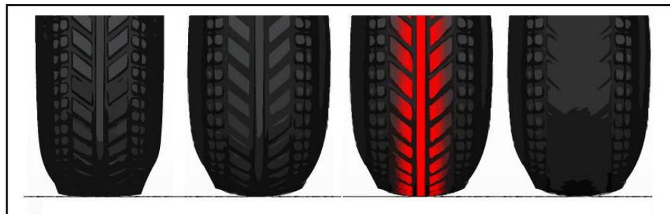
Figura 11. Neumáticos con exceso de presión de aire. [4]
