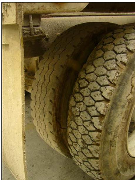
**Figura 33. Neumáticos montados de diferente tipo y diámetros.**
