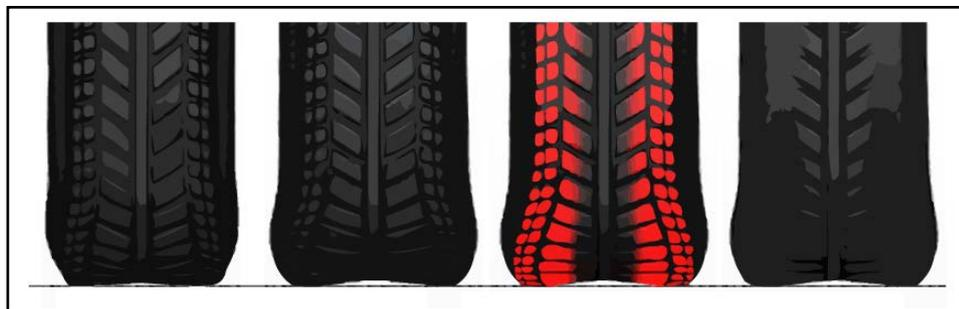
Figura 10. Neumáticos con insuficiente presión de aire. [4]
