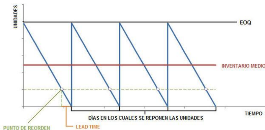
Figura 1.1: Perfil de los inventarios bajo los supuestos del modelo EOQ. [7]
