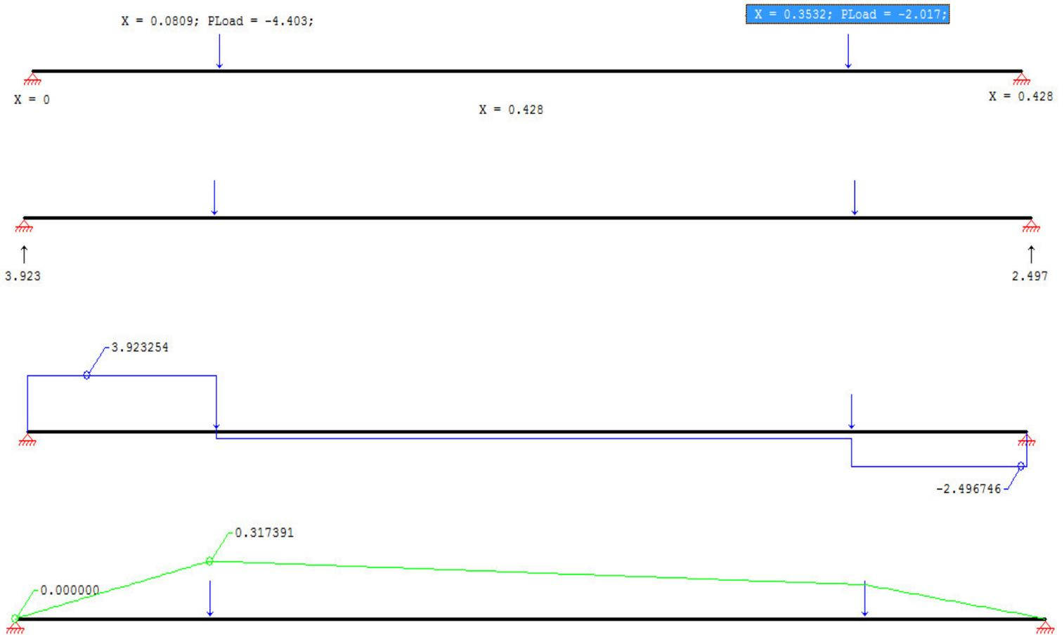
**Figura 3.15 Gráfica de las reacciones, la fuerza cortante y el momento flector del árbol de transmisión 1**
