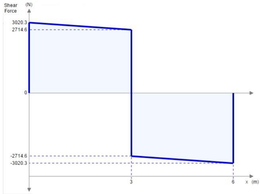
Figura 2.27 Gráfico cortantes viga transversal- diseño real (Software, 2013-2014)
