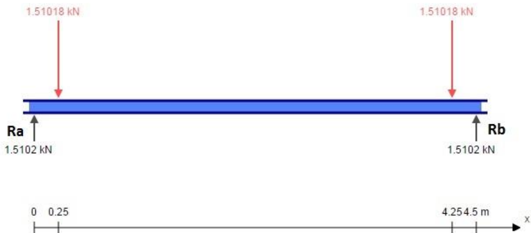
Figura 2.36 DCL en la viga soporte- pre diseño Ty (Software, 2013-2014)
