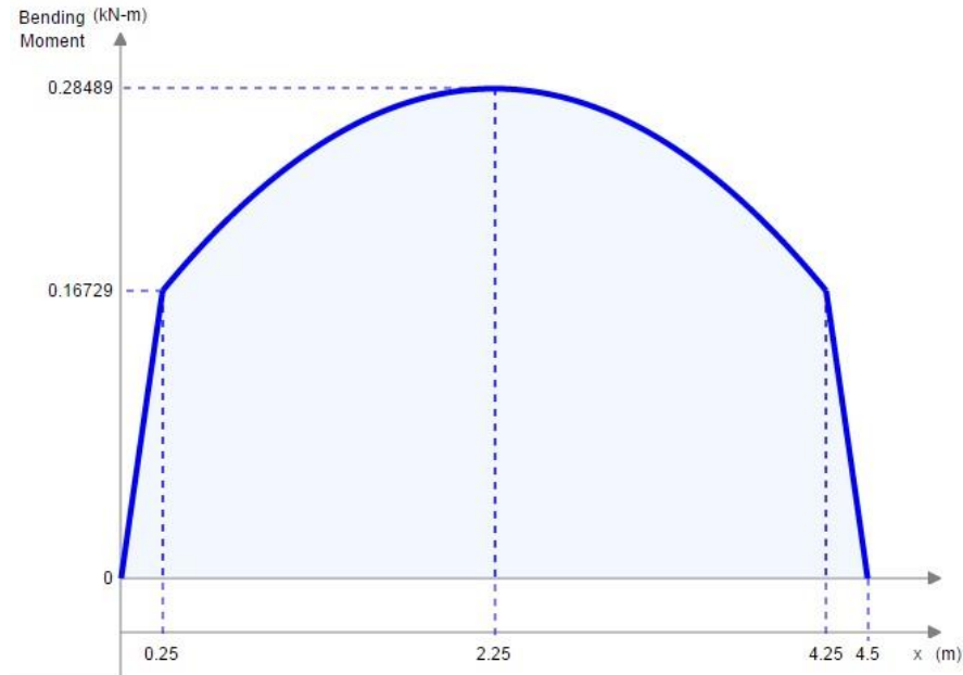
Figura 2.35 Gráfico Momentos viga soporte- diseño real Tx (Software, 2013-2014)
