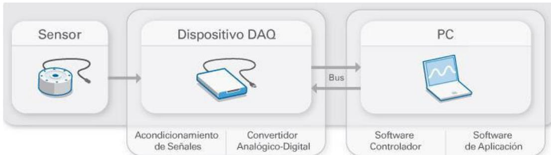
**Figura 15. Partes de un sistema DAQ**
