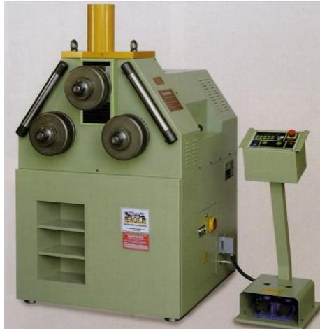
**Figura 1.5** Máquina curvadora con 1 eje Motriz
