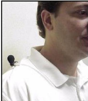
**Figura 2.7- micrófono del dosímetro**
