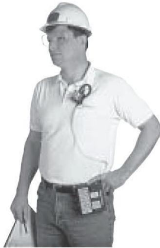
**Figura 2.9- Colocación del dosímetro de polvo**
