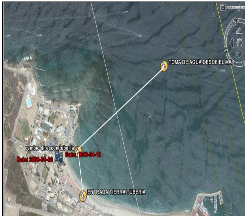
Figura. 3.31 BOSQUEJO GENERAL DE PUNTOS MAS IMPORTANTES DE LA TUBERIA SUBMARINA (GOOGLE EARTH)
