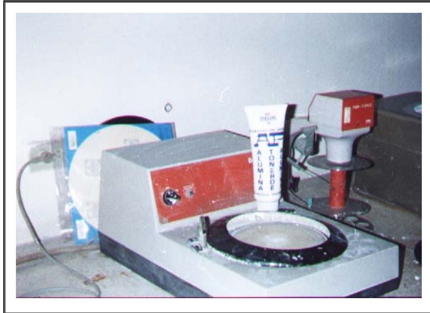
FOTO 1.2 ENSAYO METALGRÁFICO - PULIDO FINO
