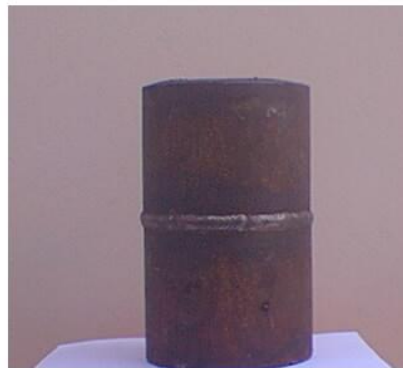
FOTO 3.3 SOLDADURA SMAW EN UN TUBO DE ACERO ASTM A53
