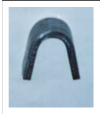
FOTO 3.2 PROBETA DE DOBLADO GUIADO DEL WPS 1
