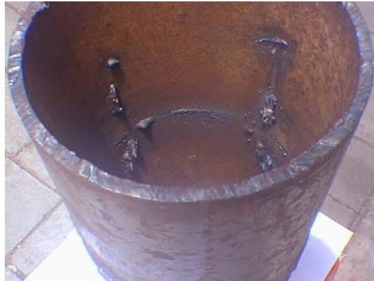
FOTO 3.8 RAÍZ DE LA SOLDADURA GMAW METAL BASE ACERO SAE 1006
