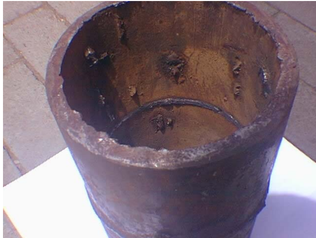
FOTO 3.4 RAÍZ DE UNA SOLDADURA SMAW EN UN TUBO DE ACERO ASTM A53
