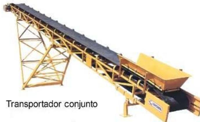
**Figura 2.7: Transportador de Banda**
