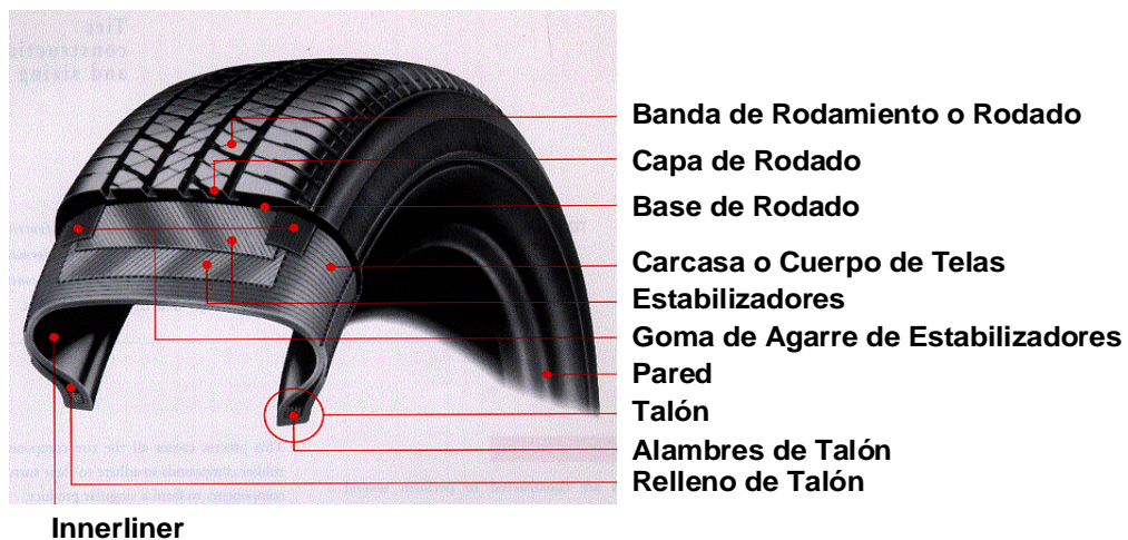
FIGURA 1.1 COMPONENTES DE LA LLANTA (A)
