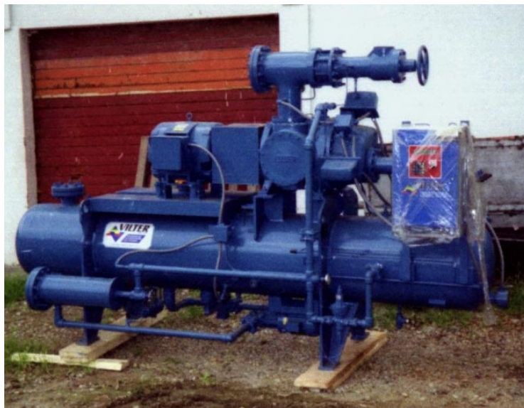
Figura 1.15. Compresor de Tornillo
