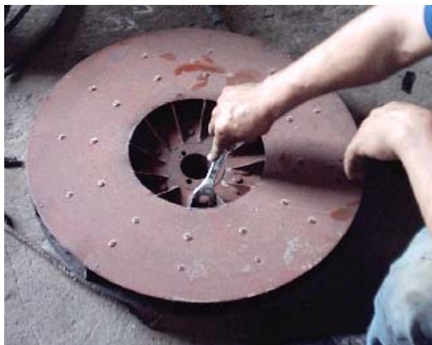
Foto 7: Ensamble del impulsor
