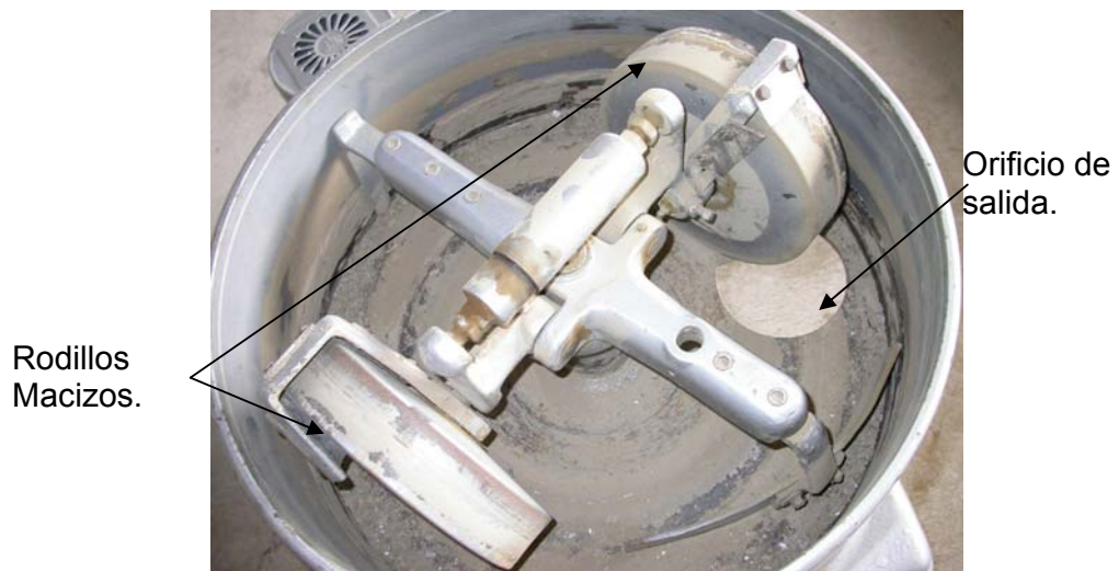
Figura 2.4. Vista Superior del Mecanismo de Mezcla.
