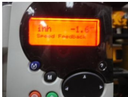
Figura 7.22: Mensaje que se muestra en la interfaz del drive al encenderse.
