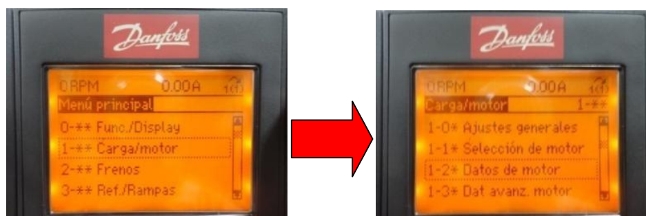
Figura 11.30: Acceso al menú Carga/motor y al submenú Datos de motor.
