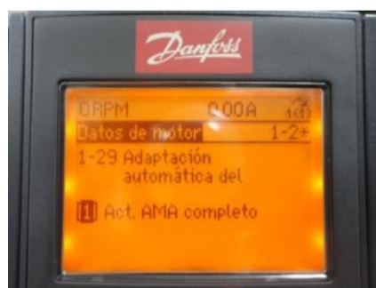
Figura 11.46: Configuración del parámetro 1-29 Adaptación automática del motor [A].
