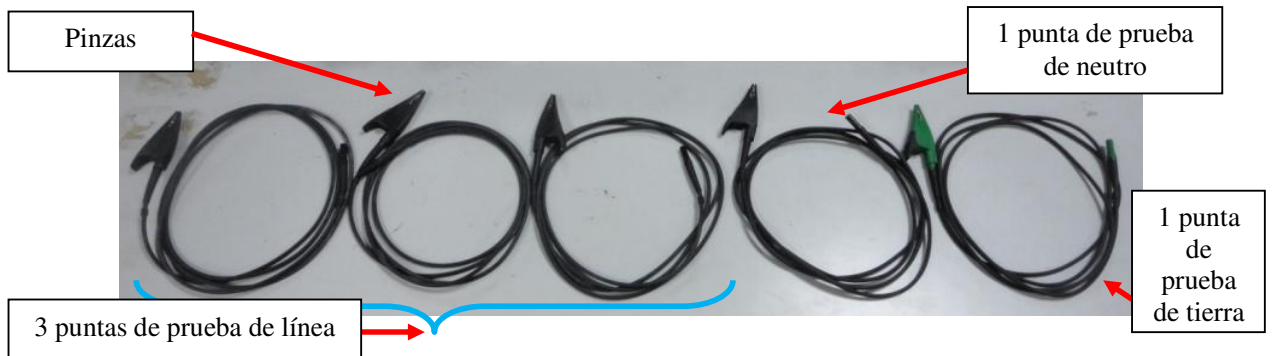
Figura 2.59: Puntas de prueba de voltaje del Analizador de energía Fluke 434
