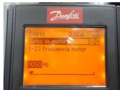
Figura 11.33: Configuración del parámetro 1-23 Frecuencia motor [Hz].
