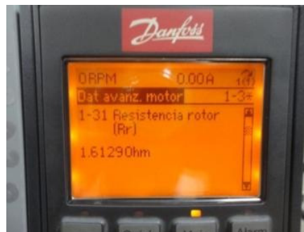
Figura 11.51: Parámetro 1-31 Resistencia rotor (Rr).
