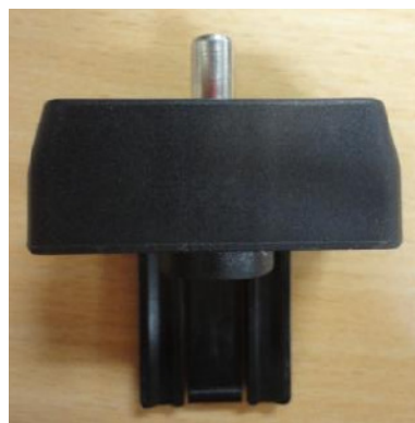
Figura 2.66: Acople mecánico del tacómetro infrarrojo TACH20.
