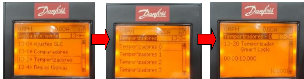
Figura 11.141: Configuración del temporizador Smart Logic.
