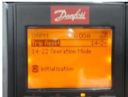
Figura 11.25: Opción 14-22 denominada Modo Funcionamiento elegida en el parámetro Inicialización.
