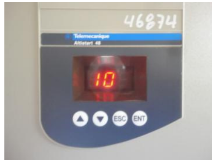
Figura 9.33: Interfaz del drive mostrando el menú IO.
