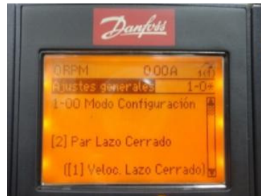
Figura 11.135: Parámetro 1-00 Modo configuración: Par lazo cerrado.
