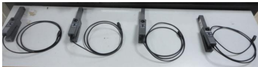
Figura 2.60: 4 puntas de prueba de corriente del Analizador de energía Fluke 434
