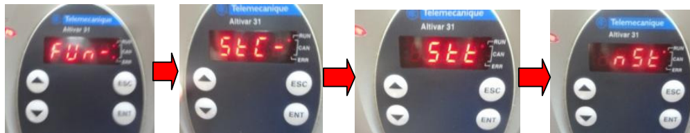
Figura 10.105: Configuración del tipo de frenado por rueda libre.
