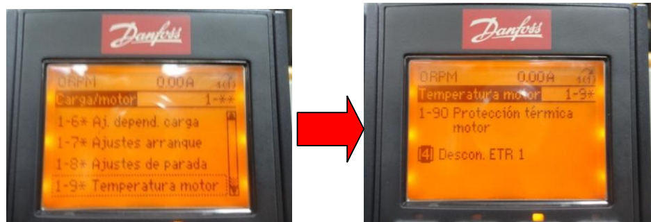
Figura 11.89: Acceso al submenú 1-9* Temperatura motor y al parámetro 1-90 Protección térmica motor.
