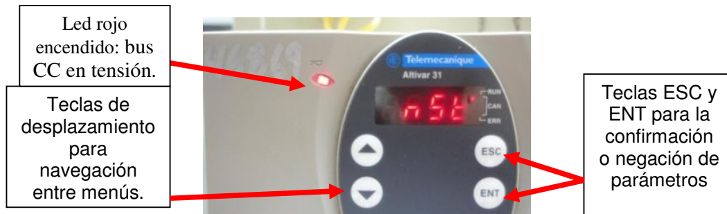
Figura 10.29: Mensaje nSt en la interfaz del drive Altivar 31.
