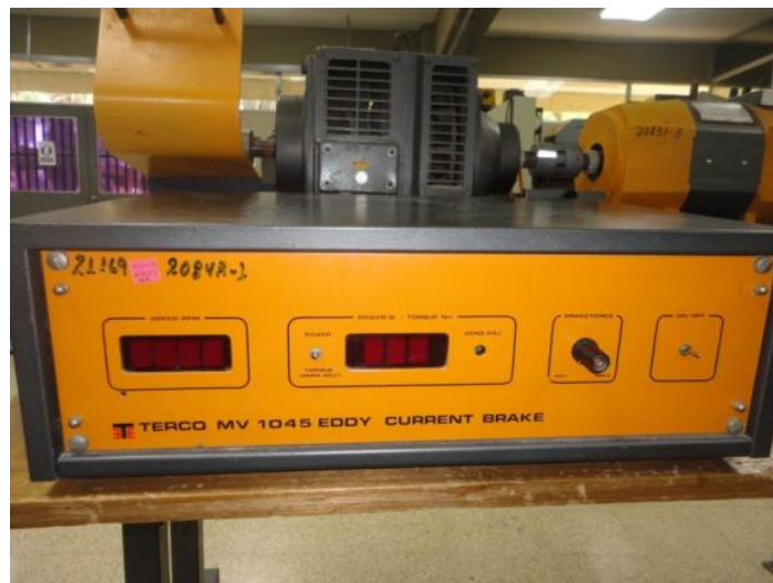
Figura 2.19: Panel frontal del control del freno por corrientes de Eddy MV1045
