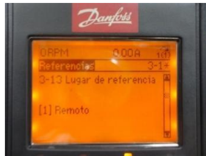
Figura 11.73: Parámetro 3-13 Lugar de referencia: remoto.
