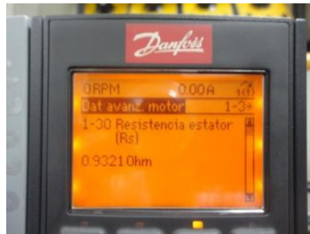
Figura 11.38: Parámetro 1-30 Resistencia estator (Rs).
