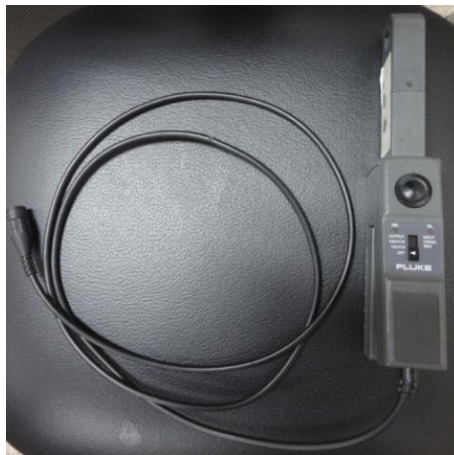
Figura 2.48: Punta de prueba de corriente a emplearse en el osciloscopio Fluke 192B.
