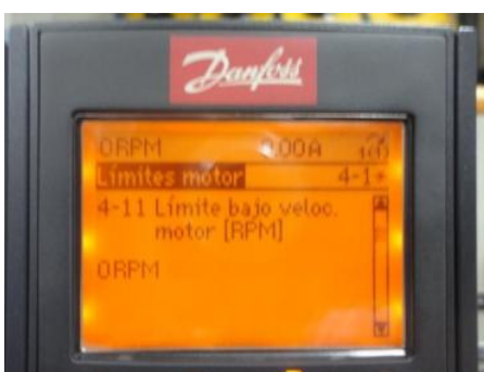
Figura 11.58: Parámetro 4-11 Límite bajo veloc. motor (RPM).
