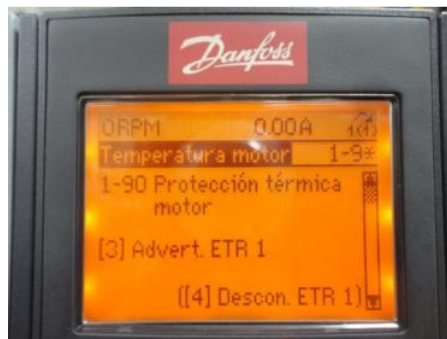
Figura 11.91: Parámetro 1-90 Protección térmica motor ajustado en Advert. ETR 1.
