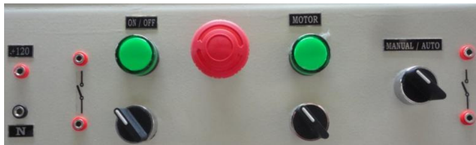
Figura 10.19: Elementos de control de la parte superior del panel Altivar.
