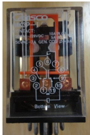
Figura 5.7: Características de los relés 1 y 2 y numeración de conexiones de los contactos auxiliares.
