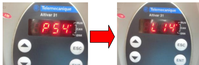
Figura 10.128: Configuración del parámetro PS4 con el valor LI4.
