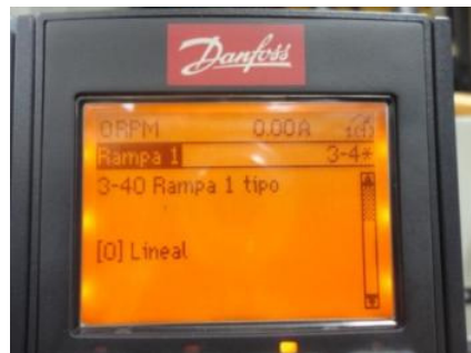
Figura 11.83: Parámetro 3-40 Rampa 1 tipo Lineal.
