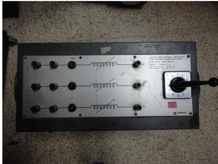
Figura 2.5: Imagen real del banco inductivo MV1101
