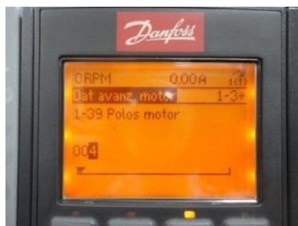
Figura 11.37: Configuración del parámetro 1-39 correspondiente a Polos motor.
