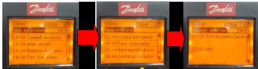
Figura 11.94: Elección del parámetro 14-00 Patrón conmutación: SFAVM.
