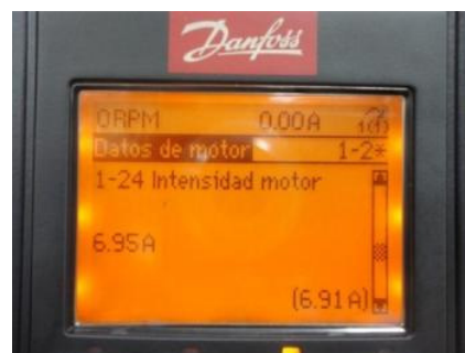
Figura 11.34: Configuración del parámetro 1-24 Intensidad motor [A].
