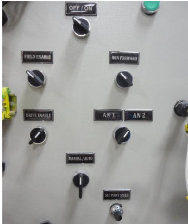
Figura 7.11: Selectores OFF/ON, field enable, run forward, drive enable, AN1 AN2 y manual/auto; potenciómetro de precisión de 10K \Omega set point speed.
