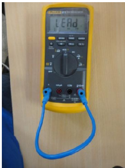
Figura 2.63: Multímetro Fluke 87V en modo resistencia y conexión necesaria mostrando el estado del fusible
