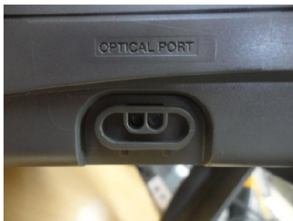
Figura 2.51: Puerto óptico del osciloscopio Fluke 192B o el analizador de energía Fluke 434.
