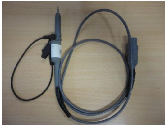
Figura 2.45: Punta de prueba de voltaje gris a emplearse en el osciloscopio Fluke 192B.
