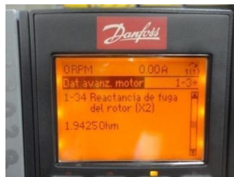
Figura 11.53: Parámetro 1-34 Reactancia de fuga del rotor (X2).
