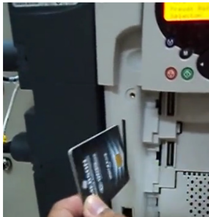
Figura 7.128: Forma de inserción de la tarjeta inteligente (Smartcard) en el drive MentorMP45A4.
