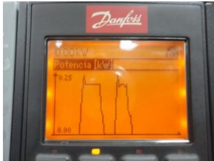
Figura 11.72: Variación de la potencia [KW] dentro del menú Registros.
