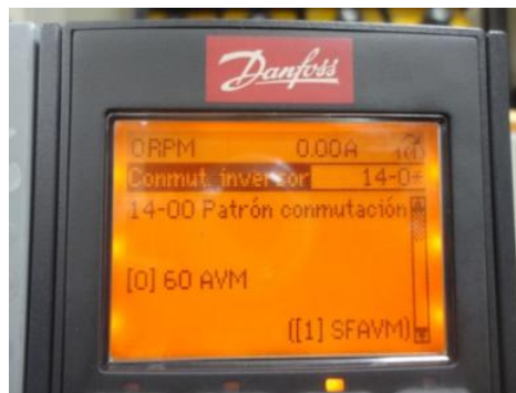
Figura 11.98: Elección del parámetro 14-00 Patrón conmutación: 60 AVM.
