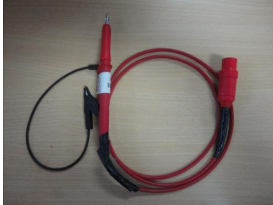
Figura 2.46: Punta de prueba de voltaje roja a emplearse en el osciloscopio Fluke 192B.
