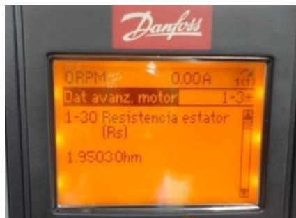
Figura 11.50: Parámetro 1-30 Resistencia estator (Rs).
