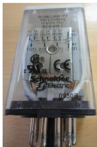
Figura 5.9: Características del relé 3 y numeración de conexiones de los contactos auxiliares.
