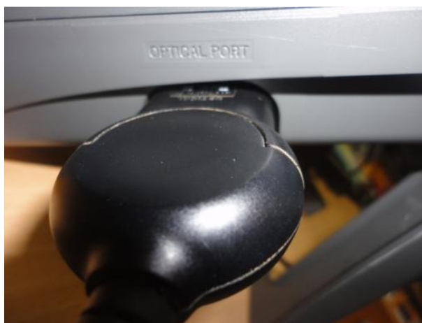
Figura 2.52: Conexión del cable de comunicación en el osciloscopio Fluke 192B o el analizador de energía Fluke 434.
