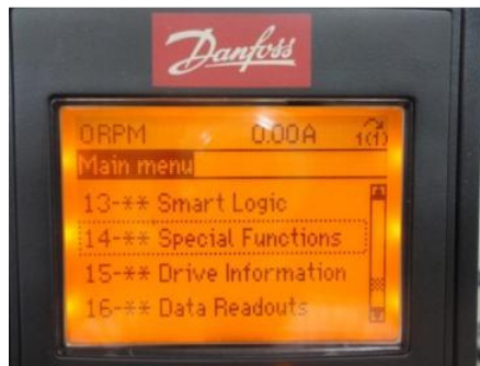
Figura 11.23: Menú 14 correspondiente a Funciones especiales.
