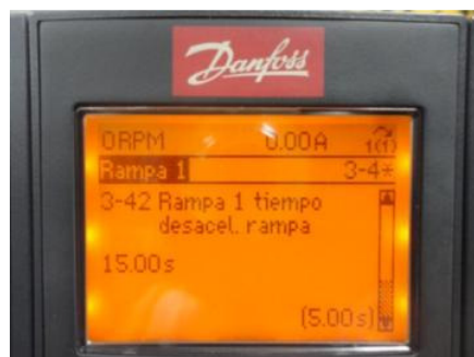
Figura 11.85: Parámetro 3-42 Rampa 1 tipo desacel. rampa.
