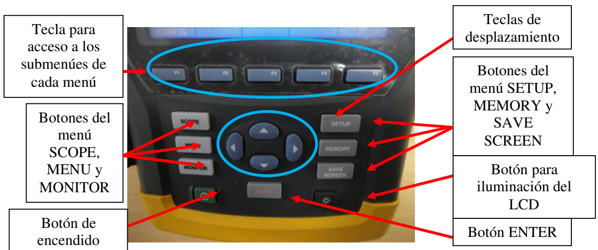
Figura 2.58: Teclado del analizador de energía Fluke 434.
