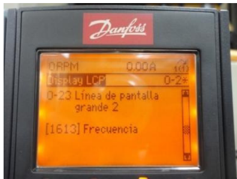
Figura 11.79: Parámetro 0-23 Línea de pantalla grande 2.
