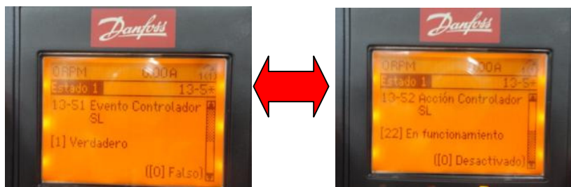
Figura 11.143: Configuración de los parámetros 13-51 Evento Controlador SL y 13-52. Acción Controlador SL para el primer estado.
