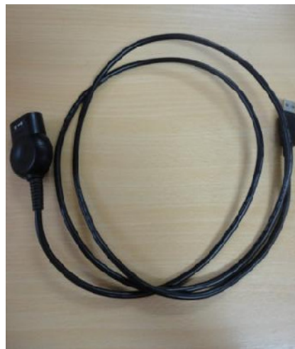
Figura 2.50: Cable de comunicación entre el PC y el osciloscopio Fluke 192B o el analizador de energía Fluke 434.
