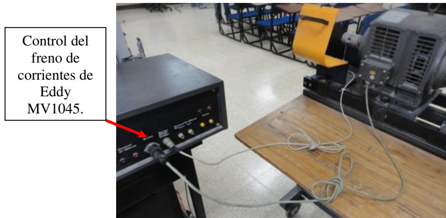
Figura 2.110: Conexiones reales entre el freno de corrientes de Eddy y su control.
