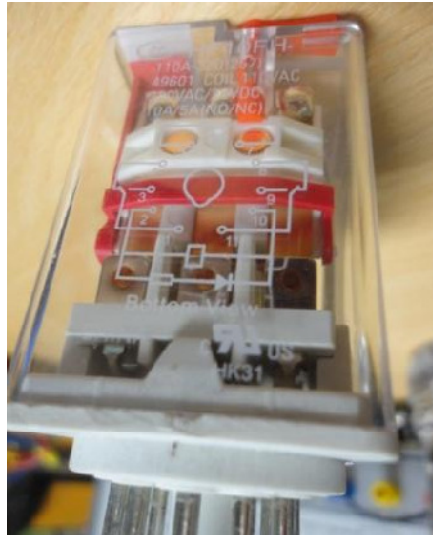
Figura 10.13: Diagrama de identificación de las terminales de los relés L1 ATV, L2 ATV, VFUN y M1.
