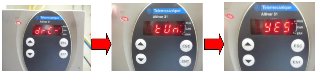
Figura 10.71: Procedimiento de autoajuste del drive Altivar 31.
