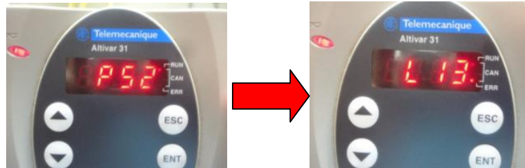
Figura 10.127: Configuración del parámetro PS2 con el valor LI3.
