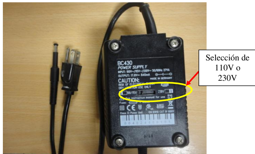
Figura 2.61: Cargador de baterías del analizador de energía Fluke 434.
