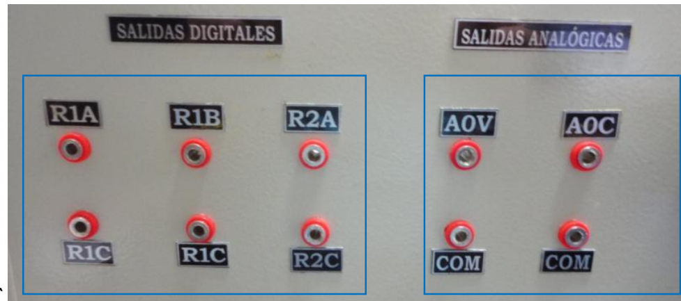
Figura 10.22: Salidas digitales y analógicas del drive Altivar 31.
