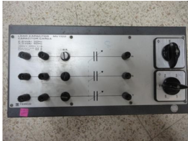
Figura 2.7: Vista superior del banco capacitivo MV1102
