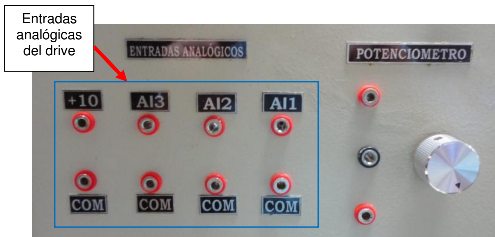
Figura 10.21: Entradas analógicas del drive Altivar 31, potenciómetro de precisión de 5K \Omega y sus terminales.
