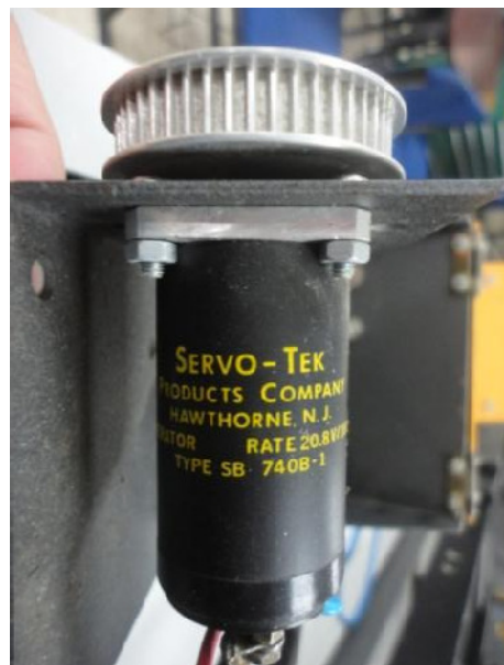
Figura 2.25: Taco-generador DC MV1024
