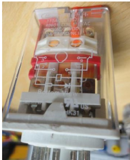
Figura 11.8: Diagrama de identificación de las terminales de los relés auxiliares.
