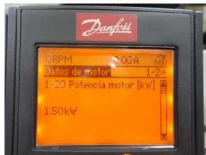
Figura 11.31: Configuración del parámetro 1-20 Potencia motor [KW].
