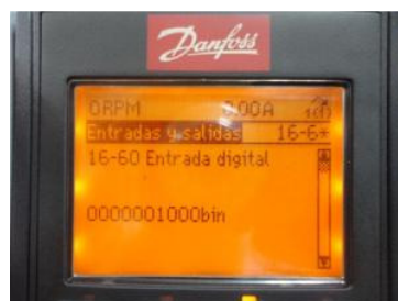
Figura 11.139: Parámetro 16-60 Entrada digital.
