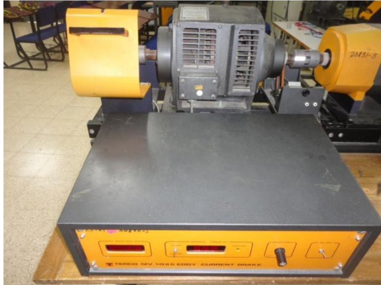
Figura 2.21: Control y freno del equipo MV1045 sobre la mesa de soporte de máquinas Terco.
