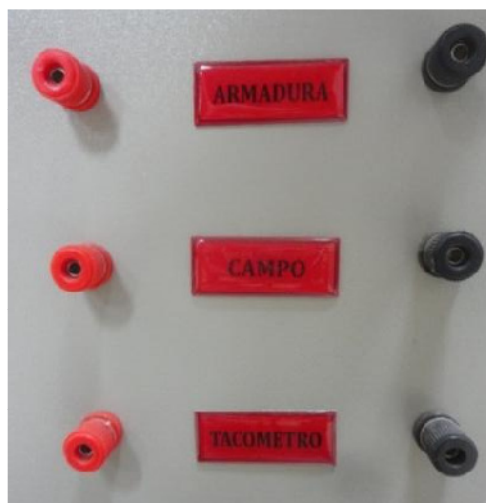
Figura 7.12: Terminales para conexión de armadura, campo y tacogenerador DC.
