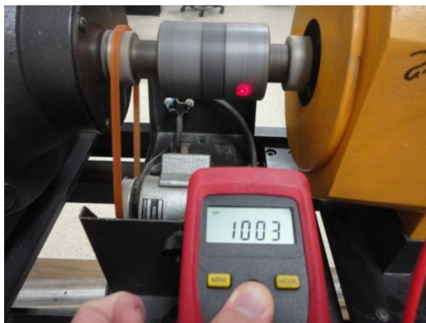
Figura 2.112: Ajuste de la velocidad en 1000rpm previo a la obtención de la curva de corriente de armadura vs velocidad de la máquina DC MV1006 en conexión excitación separada.
