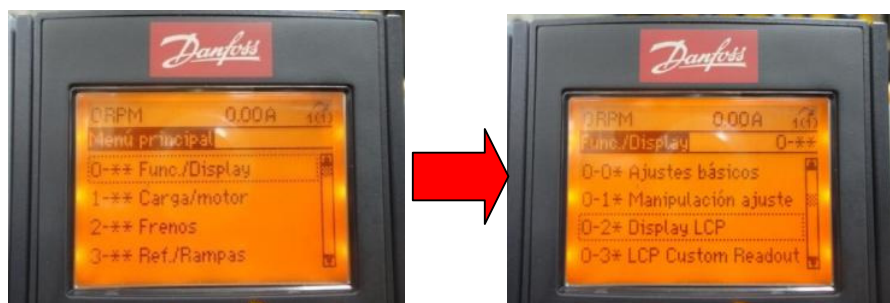
Figura 11.75: Acceso al menú 0-** Func./Display y luego al submenú 0-2* Display LCP.
