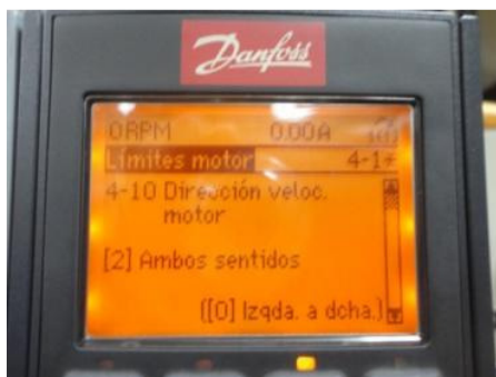
Figura 11.57: Parámetro 4-10 Dirección veloc. motor.
