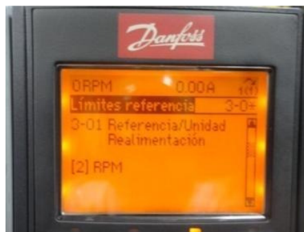
Figura 11.64: Parámetro 3-01 Referencia/Unidad realimentación.
