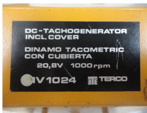
Figura 2.26: Relación de voltaje vs velocidad dada por el fabricante del taco-generator DC MV1024
