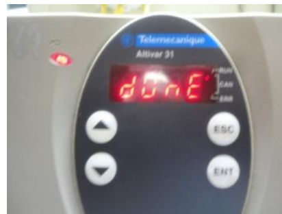
Figura 10.73: Mensaje de confirmación de finalización del autoajuste.
