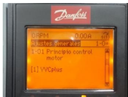
Figura 11.114: Parámetro 1-01 Principio control motor: VVCplus.
