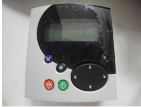
Figura 7.13: Interfaz de programación del drive Mentor.
