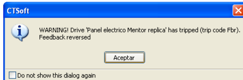
Figura 7.87: Trip Fbr indicado por el software CT-Soft.
