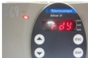
Figura 10.31: Mensaje rdY en la interfaz del drive Altivar 31.
