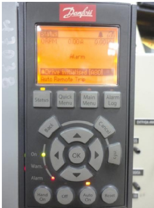
Figura 11.26: Encendido del led Alarm y el mensaje Drive initialised [A80].
