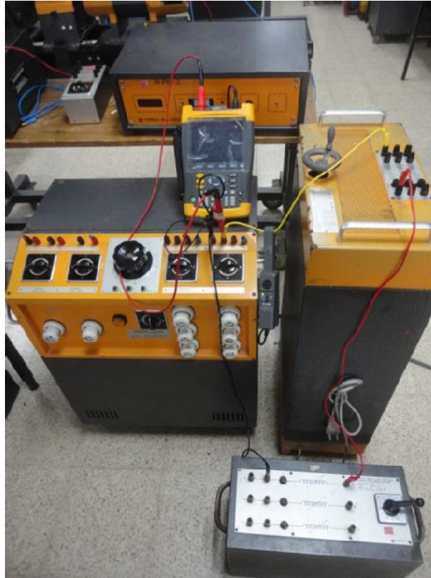
Figura 2.74: Conexión reales para la medición de inductancia.
