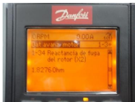
Figura 11.41: Parámetro 1-34 Reactancia de fuga del rotor (X2).
