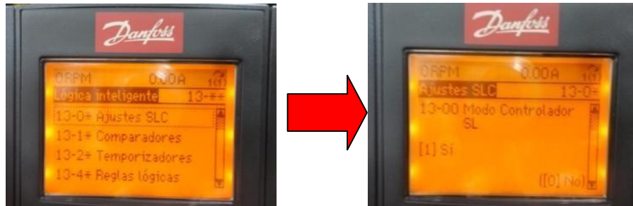
Figura 11.140: Habilitación del modo Controlador SL.
