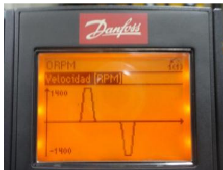
Figura 11.70: Variación de la velocidad dentro del menú Registros.
