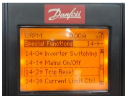
Figura 11.24: Opción 14-2* correspondiente al Reinicio desconexión.
