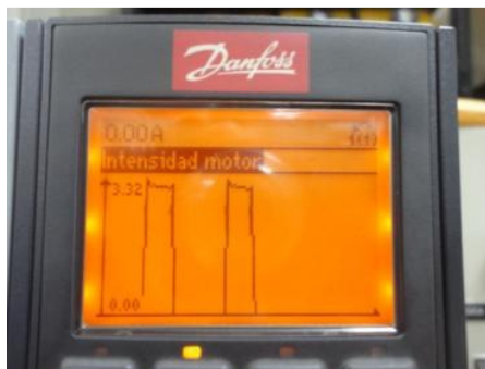
Figura 11.71: Variación de la corriente RMS dentro del menú Registros.
