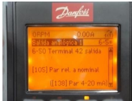
Figura 11.45: Configuración del parámetro 6-50 Terminal 42 salida.
