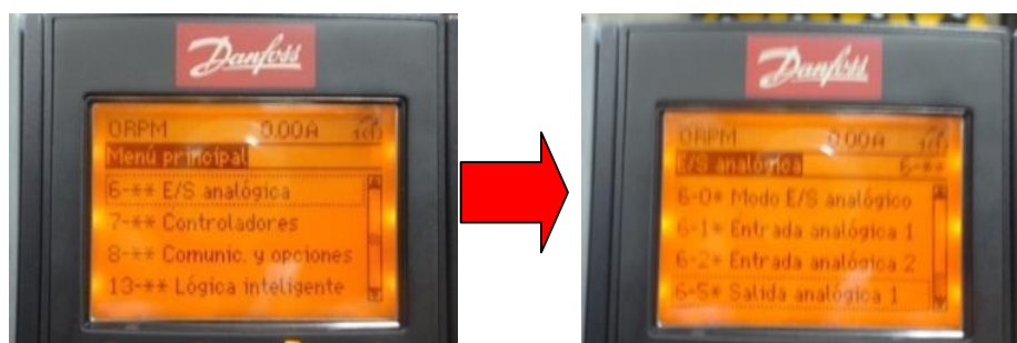
Figura 11.44: Acceso al menú 6-** E/S analógica y al submenú 6-5* Salida analógica 1.
