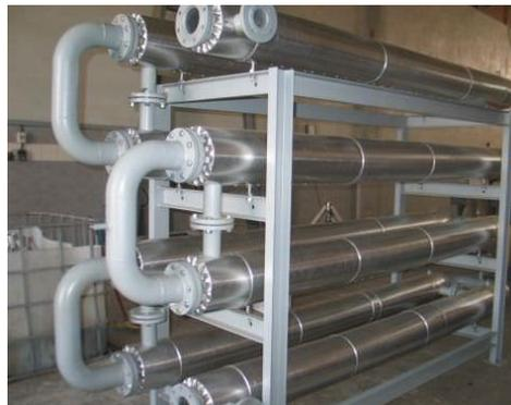
**Figura 2-2. Intercambiador de tubos concéntricos.**
