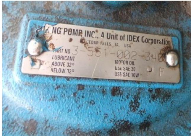
**Placa del reductor de la bomba de Fuel Oil de la planta.**
