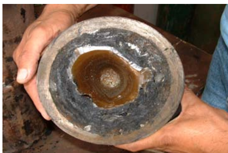
FIGURA 18: Fotografía de una tubería con obstrucción
