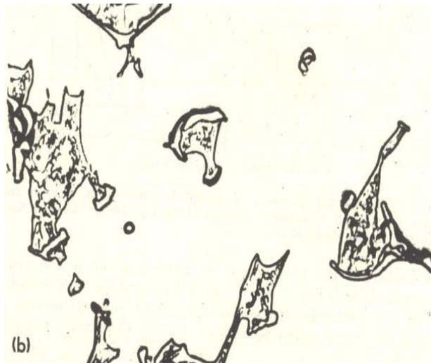
Fig. 1.9 .- Estructura de un bronce ordinario con 10% de fósforo, enfriado rápidamente. Fig 1.9(a) muestra pequeñas partículas de fase en una matriz dendrítica alfa. La fig 1.9(b) muestra la fase delta, 1000x.
