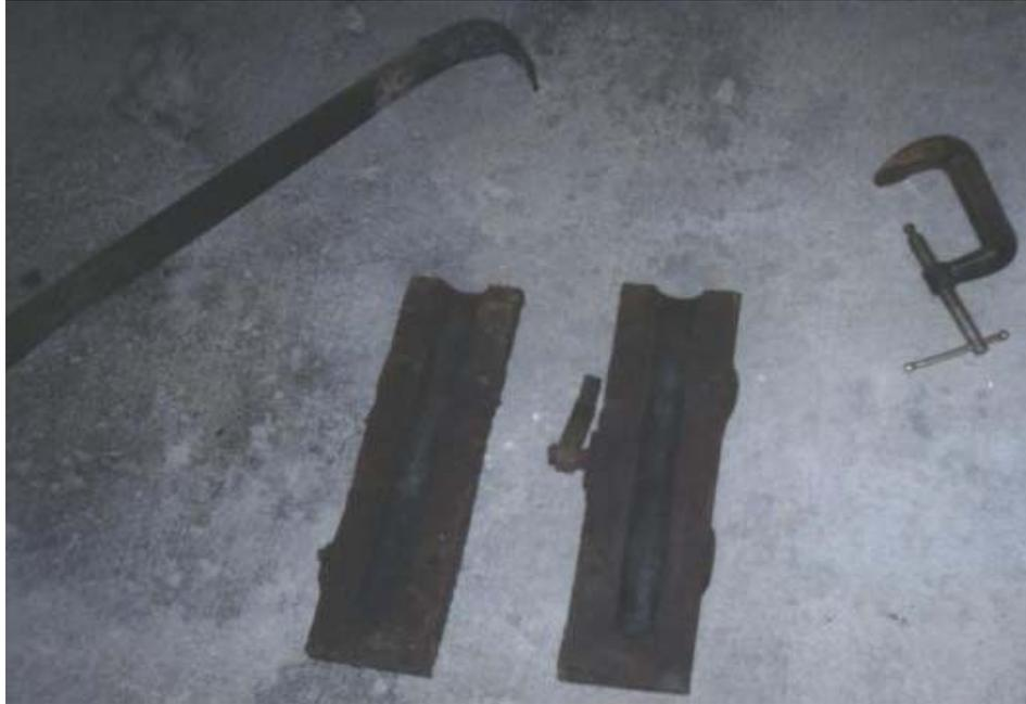
Fig. 2.2.- Probetero y separador de escoria
