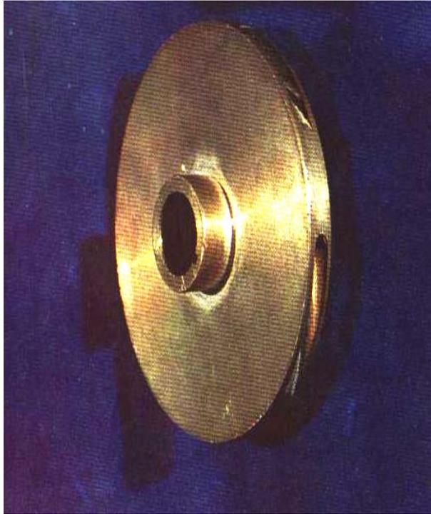
Fig. 1.3 .- Impeler para bomba centrífuga de 3" de diámetro
