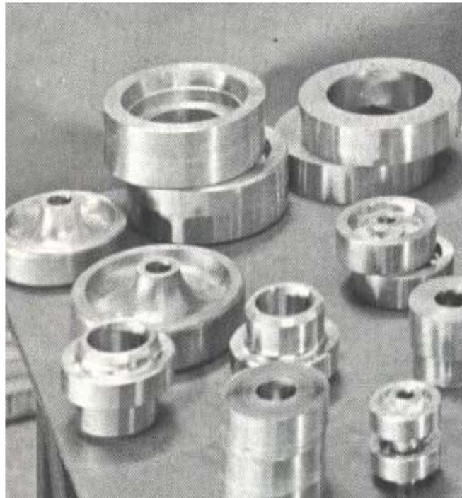
Fig. 1.15.- Piezas centrifugadas para hacer coronas. SAE 65 ( 89Cu, 11Sn )
