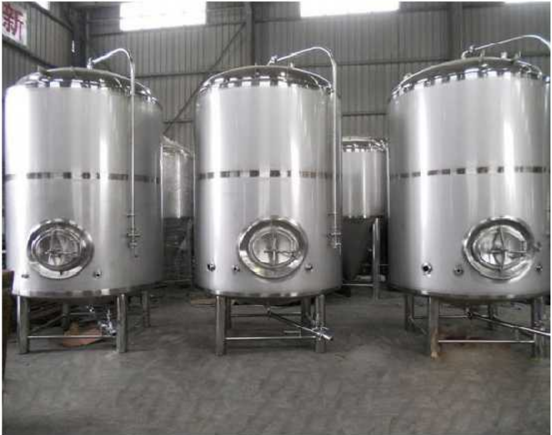
Figura 1.2. Sistema de tanques de almacenamiento
